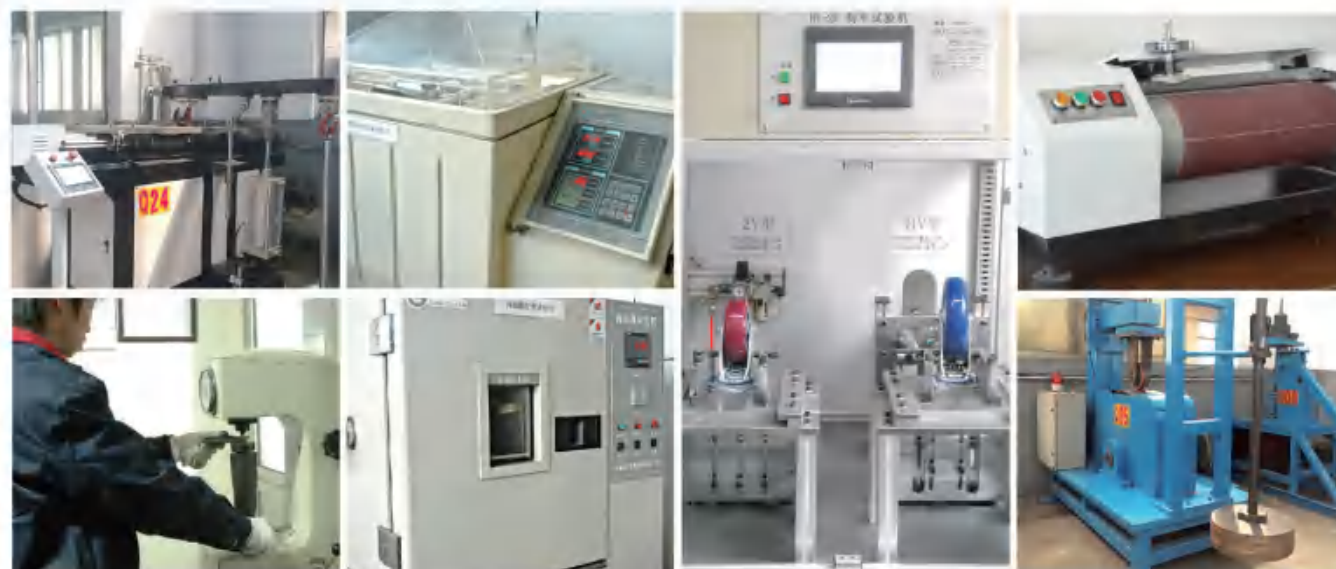
盐雾试验 / 刹车空载制动测试 / 刹车疲劳试验 / 高低温试验 / 行走测试 / 回转测试 / 拉力试验 / 磨损测试 / 影像测量 / .....
